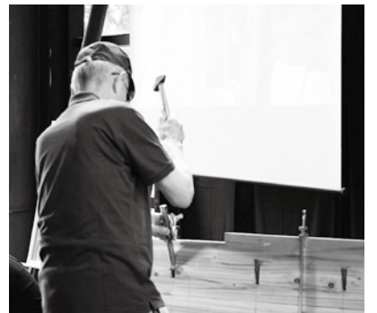
落とし釘の実演。二枚の板を縫うように接ぐ。
